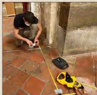
Le sol de la basilique a été scruté par le radar; des anomalies ont été relevées.
